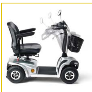
Columna de conducción
